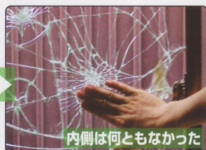
防犯フィルム・施工後
